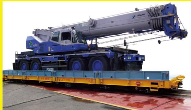
低床式大型資機材運搬台車
